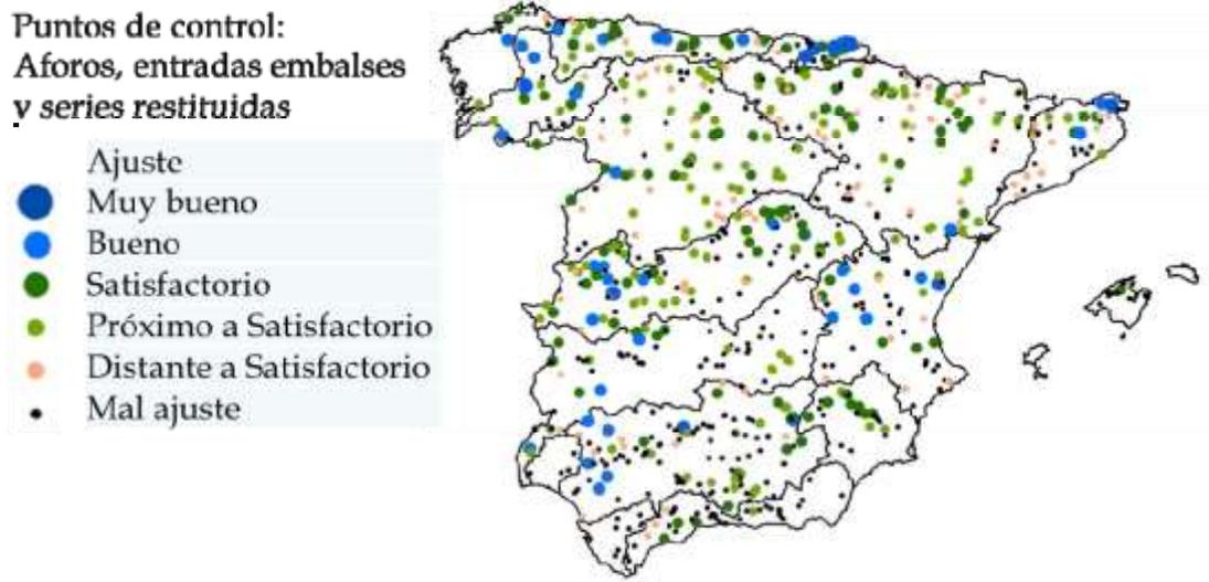
Figura 11. Ajuste entre los resultados del modelo y los caudales observados o restituidos a régimen natural, criterios de Moriasi et al. (2007).
